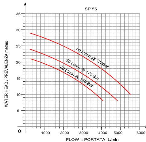
*La SP55 è una potente pompa ad immersione per acque luride con bocca da 5,5" ideale in interventi mobili nello svuotamento e movimentazione rapida di grandi volumi di acqua, nel noleggio come pompa "well point", nella protezione civile e nel settore militare, in lavori di sollevamento fognario, negli impianti di depurazione e trattamento acque e nel movimento di grandi volumi di fluidi carichi.*
