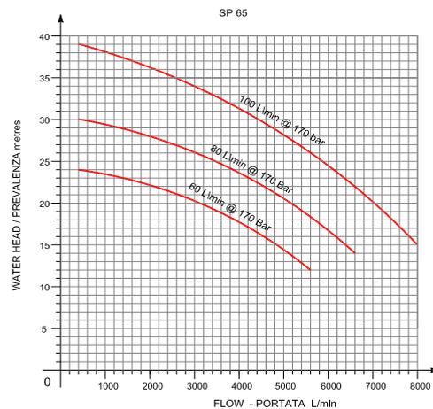
*La SP65 è una potente pompa ad immersione da 6" per acque luride ideale in interventi mobili nello svuotamento e movimentazione rapida di grandi volumi di acqua, nel noleggio come pompa "well point", nella protezione civile e nel settore militare, in lavori di sollevamento fognario, negli impianti di depurazione e trattamento acque e nel movimento di grandi volumi di fluidi carichi.*
