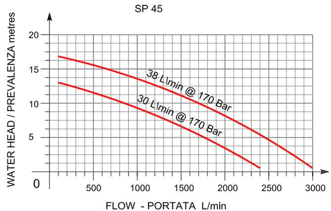
*La SP 45 è una pompa ad immersione professionale progettata per il pompaggio di acque luride o molto fangose con concentrazione di fango nel liquido fino al 25%, può aspirare corpi solidi in sospensione con dimensioni di 70 mm. E' azionabile da piccole centraline, dal circuito idraulico di escavatori, autocarri, trattori e da tutte le macchine dotate di un circuito idraulico idoneo.*
