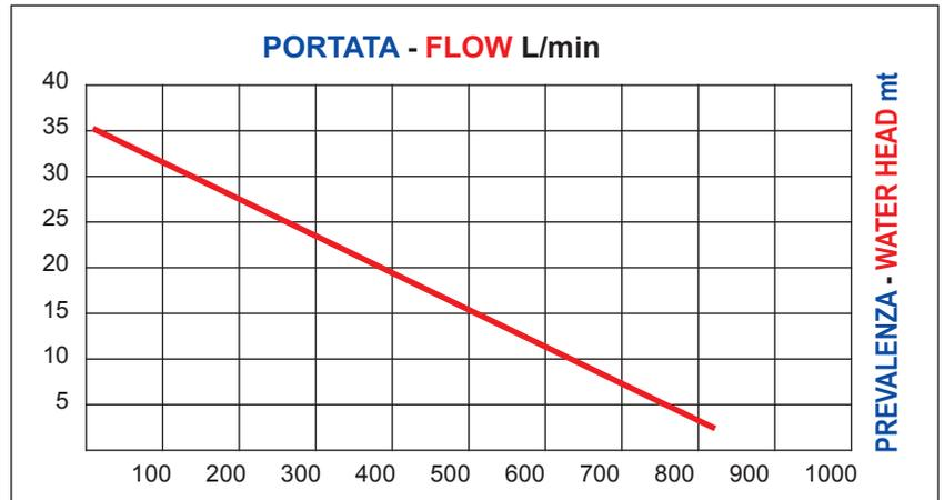
*La SP20 e' una piccola e potente pompa ad immersione per acque luride e fangose con portata fino a 800 L/min e prevalenza 35 metri (pressione max 3,5 bar), la pompa può aspirare corpi solidi in sospensione con dimensione fino a 3cm e pompare fluidi anche molto densi.*
