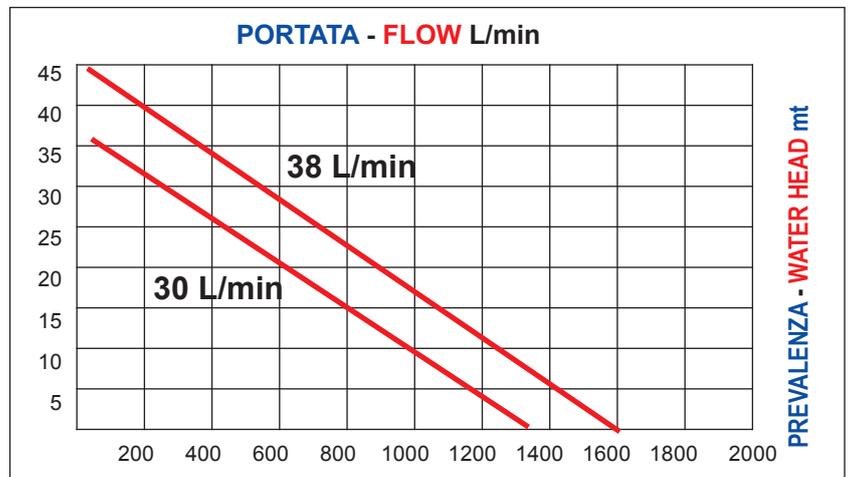
*La WP 25 è una pompa ad immersione professionale ad azionamento oleodinamico progettata per il pompaggio di acque chiare o fangose e con corpi solidi in sospensione con dimensioni fino a 20 mm.*
