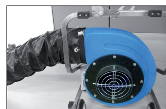
Dettaglio del sistema di installazione rapida delle manichette
