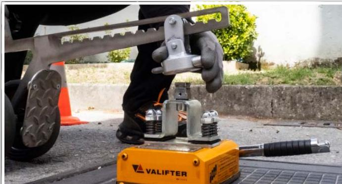
Il magnete Rhino Slim Damped integra l'attacco rapido unificato, rendendo il magnete compatibile con ogni sistema di sollevamento.
